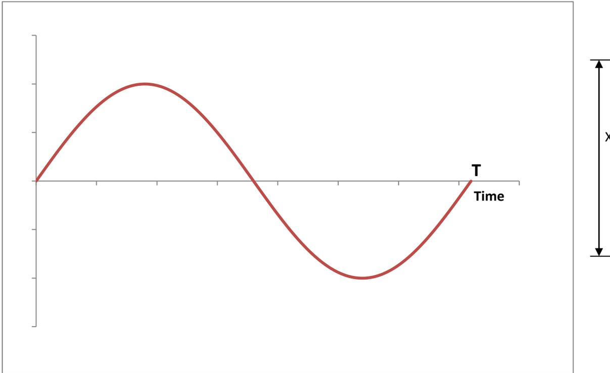
$$x(t) = \frac{X}{2} \sin(\omega t) \quad \text{Position Equation}$$
